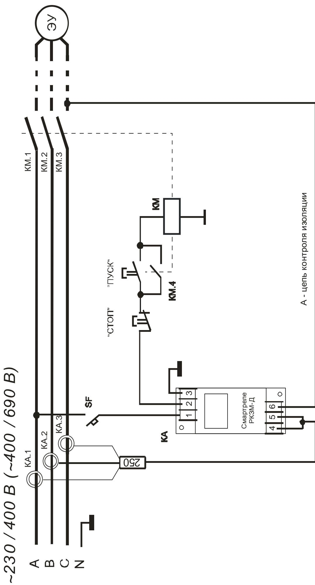
Рисунок 4 – типовая схема включения реле в систему управления электроустановки
